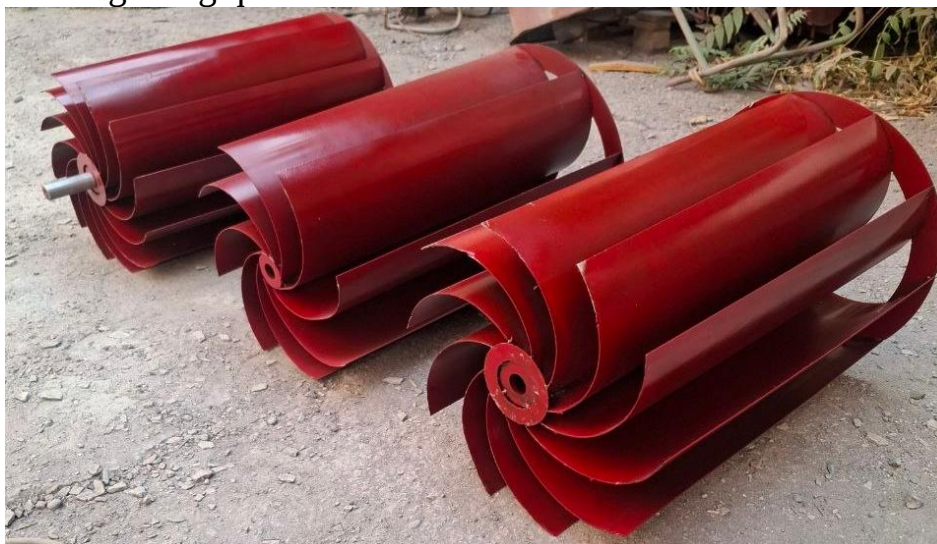
2-rasm. Egri kurakchali quritish agentini girdob shaklida aylantirgich moslamasi moslamalarni tayyorlangan variantlari ko'rinishi
